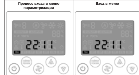
Стрелками «вверх» или «вниз» устанавливаются часы. Переход к редактированию минут — нажать кнопку «вентилятор». Стрелками «вверх» или «вниз» устанавливаются минуты. Переход к редактированию даты — нажать кнопку «вентилятор».
