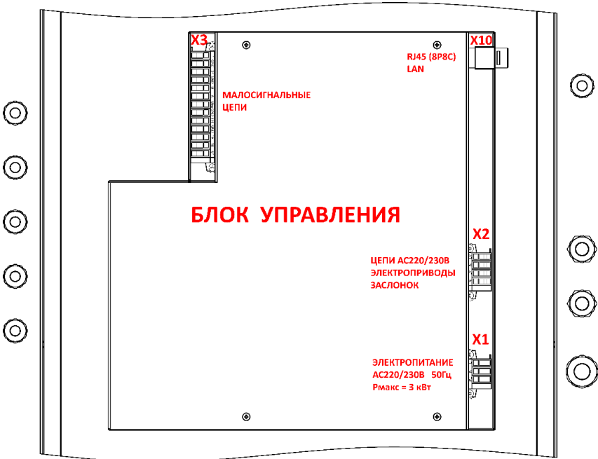
Рис. 2 Расположение клемм
