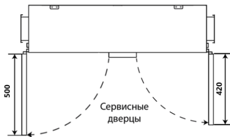
Рис. 6. Сервисное пространство снизу
