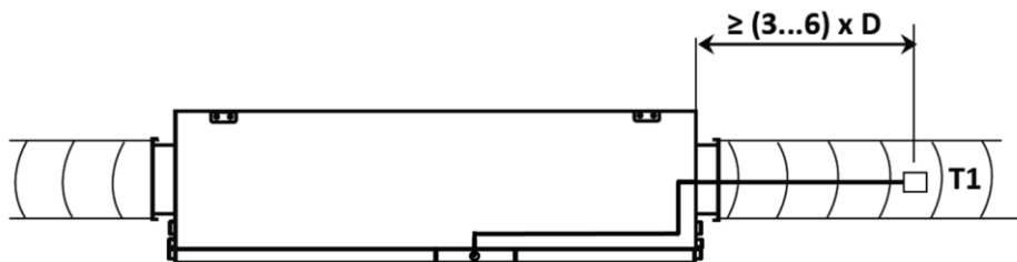
Рис. 12. Установка датчика температуры приточного воздуха
