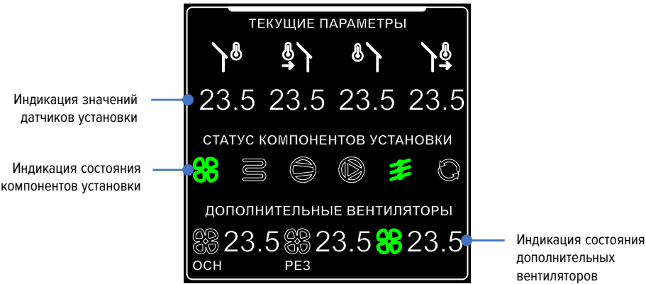
Рис. 26. Информация о состоянии компонентов установки
