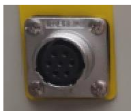
Порт подключения выносного термогигростата
