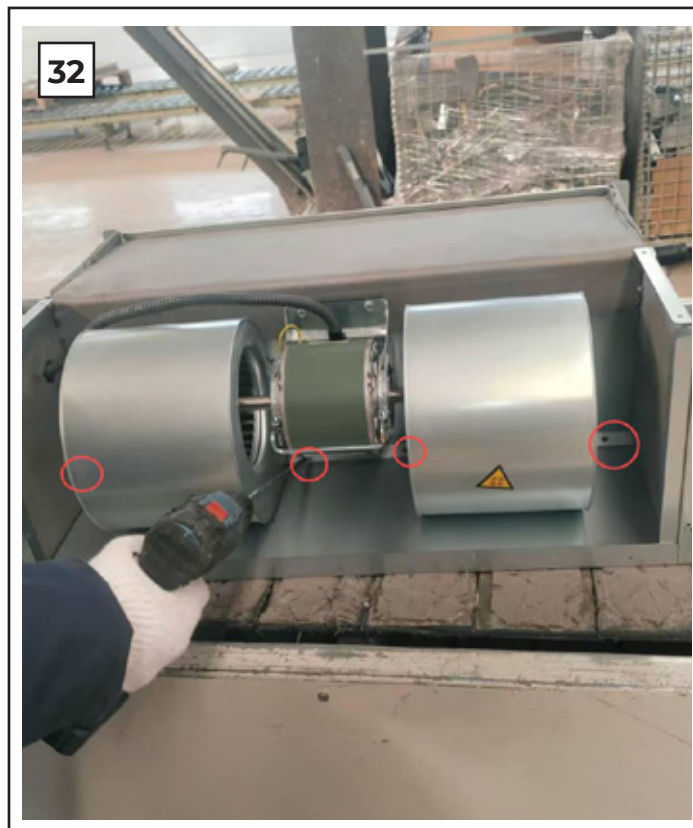
31-32: Затяните винты крепления теплообменника и боковой панели, рис. 31 (с обеих сторон), затяните 4 винта крепления теплообменника к верхней панели рис. 32 .
