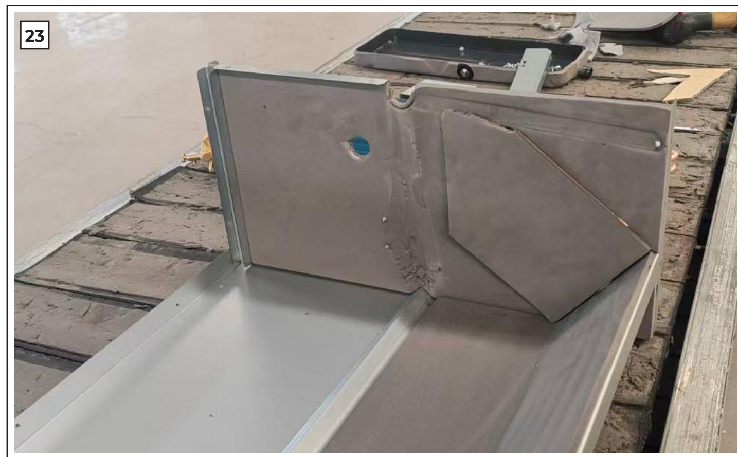
21-23: Вырежьте отверстия в теплоизоляции с правой стороны для вывода теплообменника, как показано на рис. 22 , оставшуюся изоляцию перенесите на левую сторону, как показано на рис. 23 .
