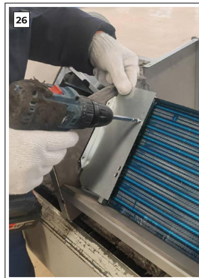
24-27: Вставьте теплообменник в отверстия на боковой панели рис. 24, затяните винты как показано на рис. 25-27 .
