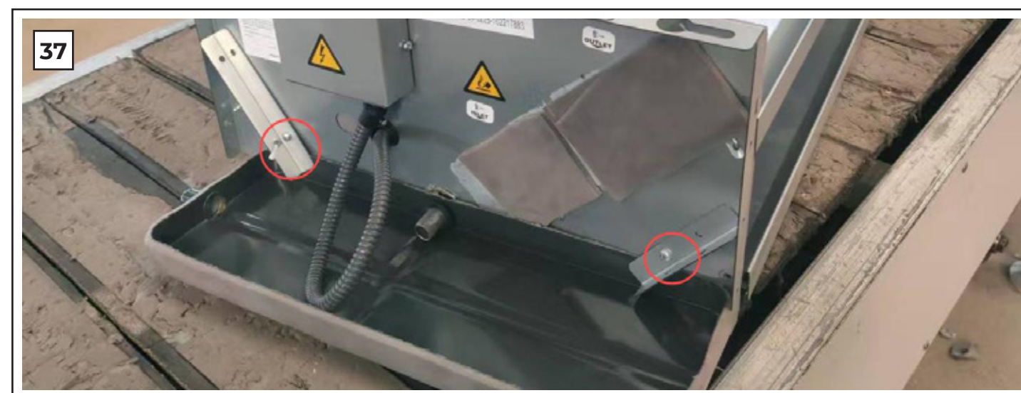
36-37: Установите боковой поддон, как показано на рис. 36-37
