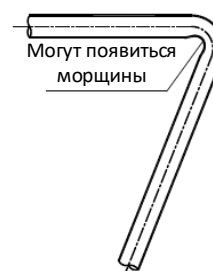
Рисунок 3-5.3. Сгибание труб более чем на 90°
