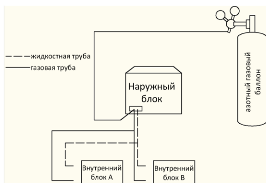
Рисунок 3-5.13. Последовательность промывки труб 1
