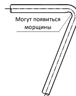
Рисунок 3-5.3. Сгибание труб более чем на 90 °
