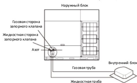
Рисунок 3-5.14. Испытание на газонепроницаемость
