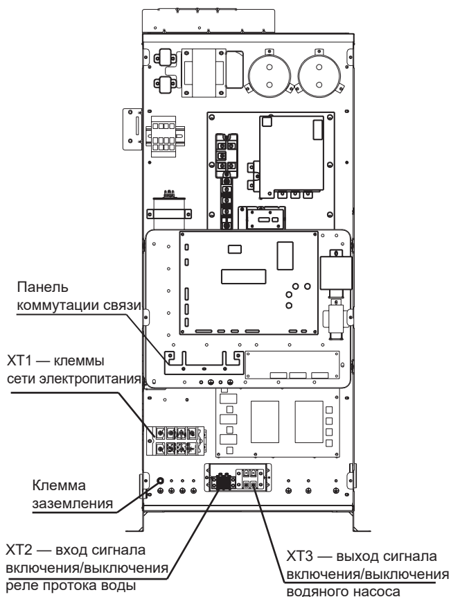
Рисунок 7-1. Схема электрического блока управления
