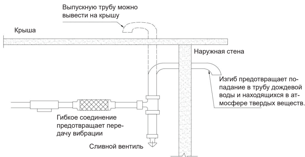
Рисунок 3.7. Подсоединение выпускной трубы предохранительного клапана
