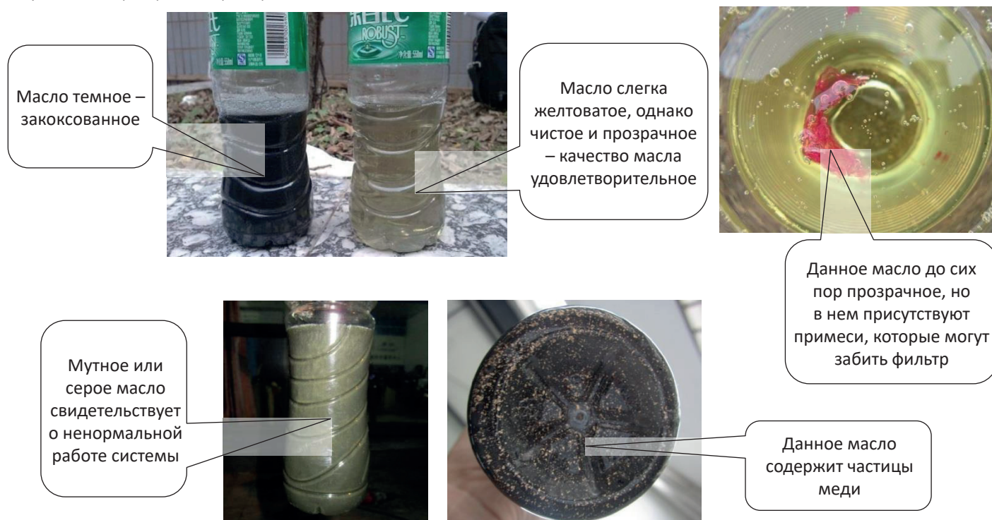
Рисунок 6-2.7: Проверка компрессорного масла
