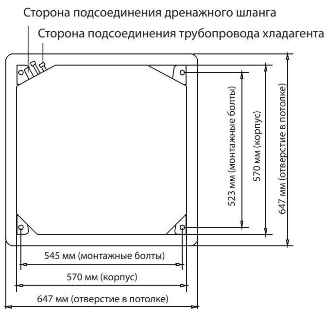
Отверстие в потолке для компактных моделей
