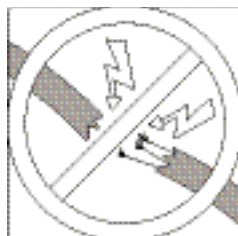
Проверьте кабели на отсутствие повреждений
