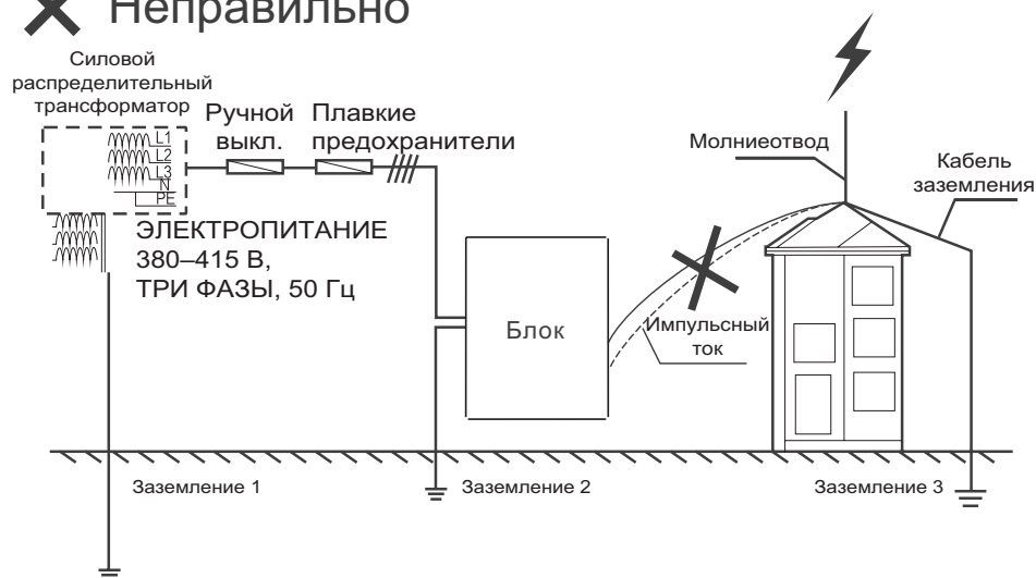
Рисунок 8-16. Требования к проводке электропитания
