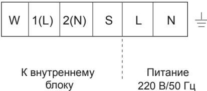
Клеммы для подключения проводов на наружном блоке
