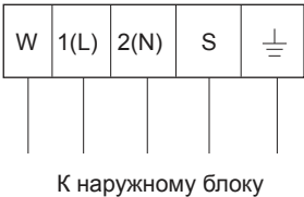
Клеммы для подключения проводов на внутреннем блоке
