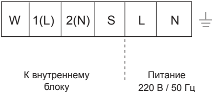
Клеммы для подключения проводов на наружном блоке
