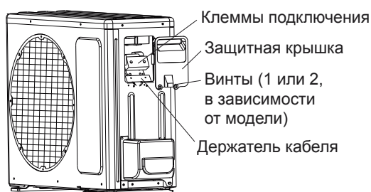
Клеммы подключения проводов
