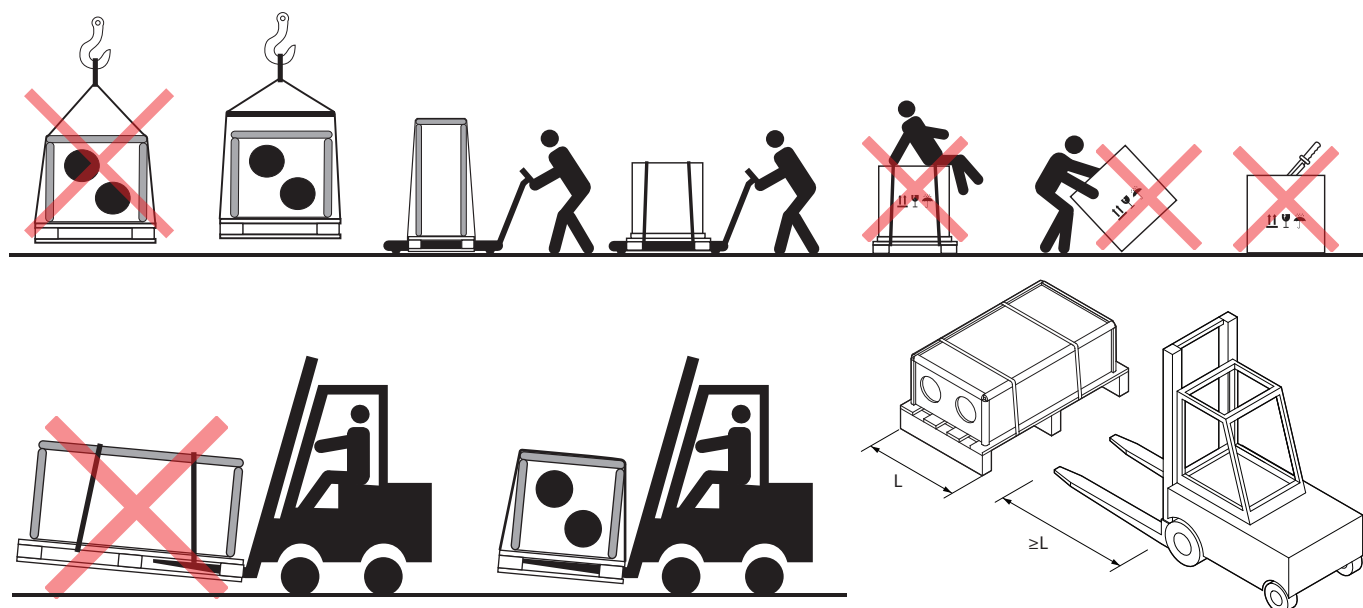
Рис. 4. Примеры транспортировки при помощи крана, автопогрузчика и технологической тележки
