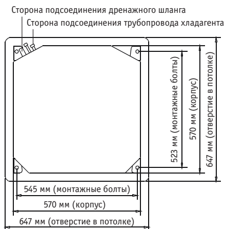
Отверстие в потолке для компактных моделей
