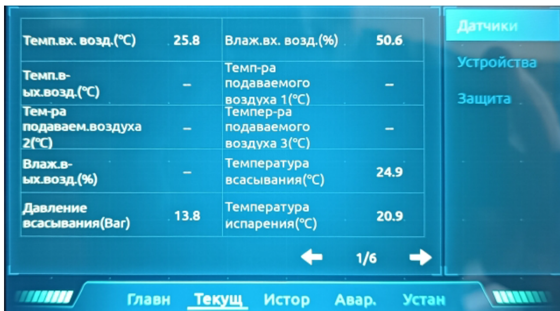
Меню Sensor Status (Датчики) - Показания датчиков
