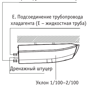
Д. Подсоединение трубопровода хладагента (D – труба газовой линии)
