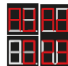
«AU Ad» обозначает автоматическую адресацию, «X» обозначает адрес НБ, «YZ» обозначает количество обнаруженных ВБ; на рисунке выше представлены 23 ВБ, которые были обнаружены.
