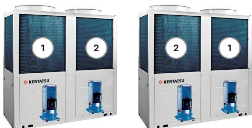
Изменение последовательности пуска компрессоров для выравнивания часов наработки и увеличения срока службы
