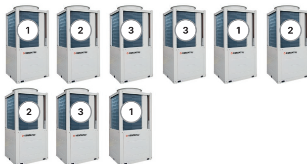
Изменение последовательности пуска чиллеров для выравнивания часов наработки и увеличения срока службы
