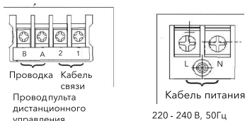
Увеличенный вид проводки клеммной коробки (ТВ), деталь P
