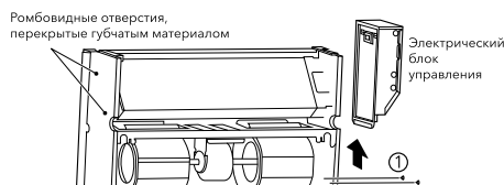
Рисунок 5-19. Отсоединение электрического блока управления и перекрывание ромбовидных отверстий
