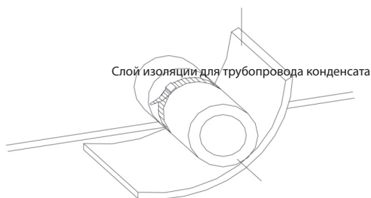
Рисунок 13. Теплоизоляция дренажной трубы
