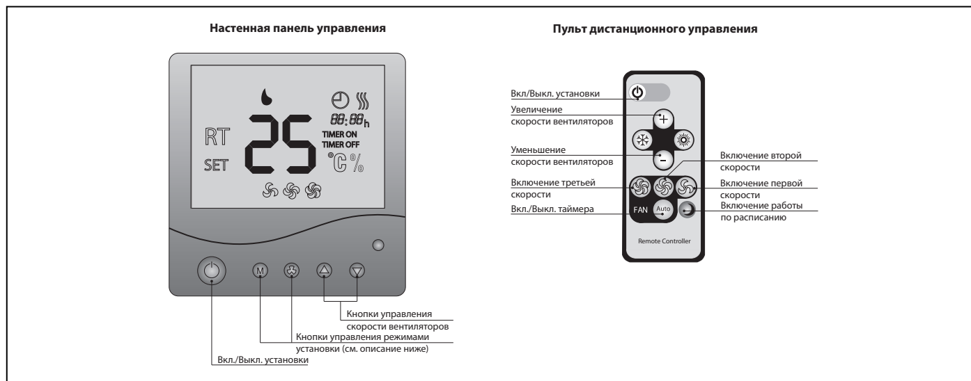
Рис. 10. Настенная панель управления и пульт дистанционного управления
