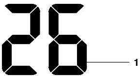
1 – Индикатор текущей температуры
